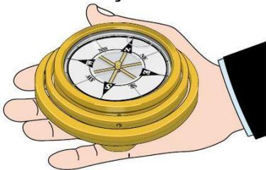
A bússola é um meio de orientação também utilizado. Ela é um instrumento com formato de relógio, possuindo uma rosa dos ventos no interior e uma agulha imantada, no lugar dos ponteiros, que aponta sempre para o norte. Desta forma, pode se encontrar os outros pontos cardeais.
